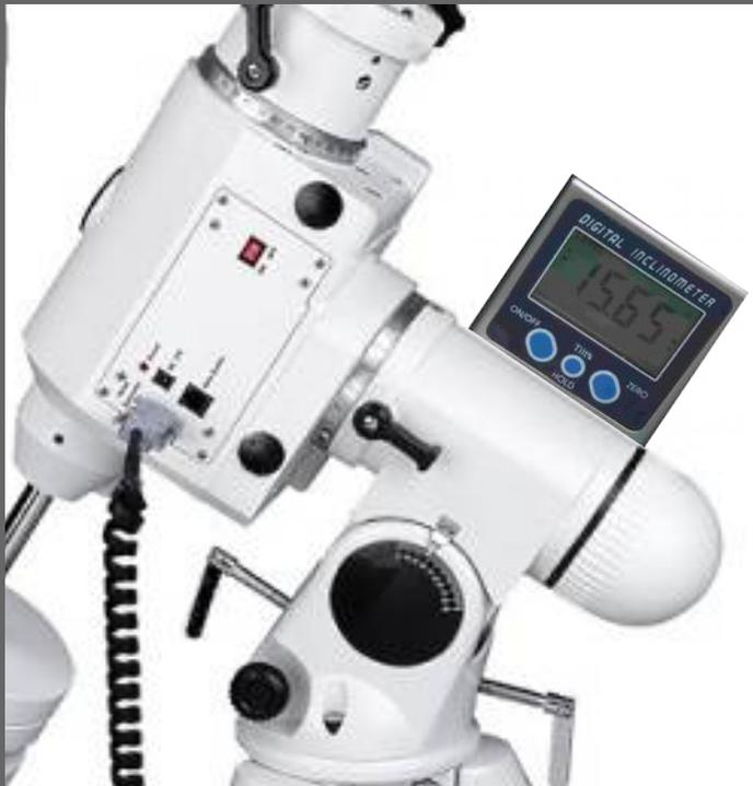
On pose l'inclinomètre sur la partie cylindrique du corps de l'axe polaire de la monture
