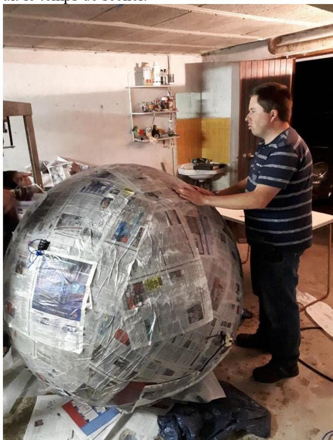
Une nouvelle tentative de ballon de baudruche enrubanné de bandages à plâtre en tissu de verre puis de résine, résiste à l'épreuve du séchage. Des couches successives de résine, entrecoupées de travaux de ponçage des aspérités, sont mises en œuvre pendant l'hiver 2018-2019 pour aboutir à un résultat satisfaisant à la fois en diamètre et en état de surface.
