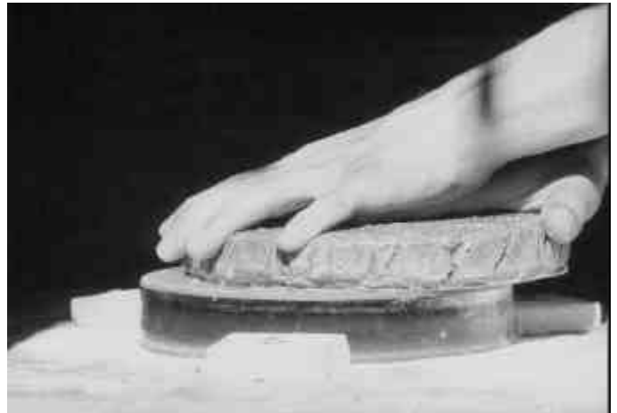
Taille du miroir. Par des mouvements aléatoires d'abrasion, le futur miroir prend une forme concave
