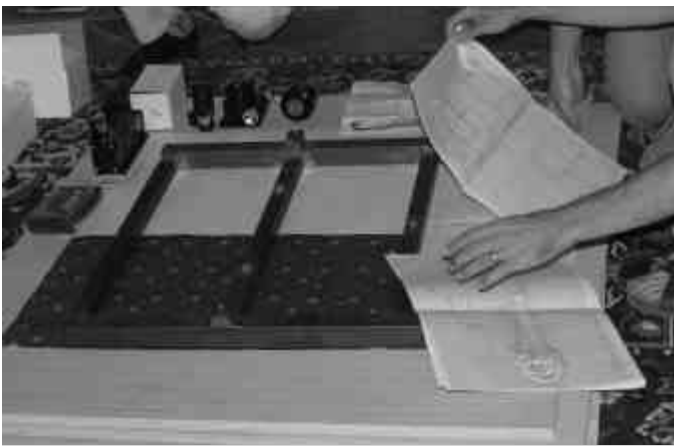
Structure mécano-soudée qui supporte le barillet et le miroir
