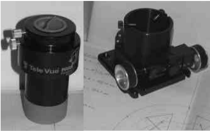
Le correcteur Tele Vue et le porte-oculaire
