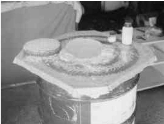
Le poste de travail de Sébastien. Le miroir repose sur un plan très stable. Il est maintenu par trois fixations
