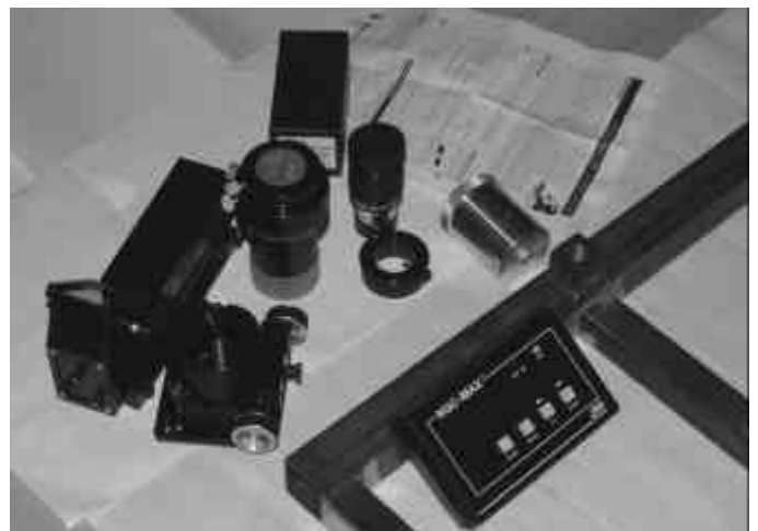
Les composants approvisionnés : Telrad, porte-oculaire, correcteur de coma, Nagler 5mm, Laser pour la collimation, boîtier encodeurs NGC-MAX
