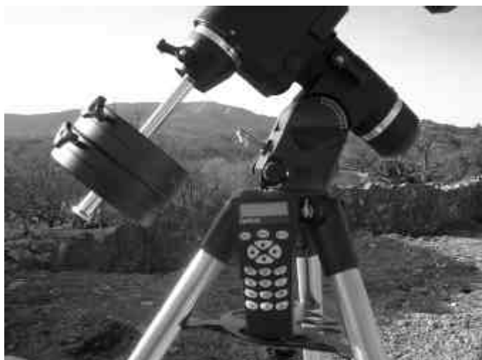
La monture Sky-Watcher HEQ-5 et la raquette de commande du système Goto
