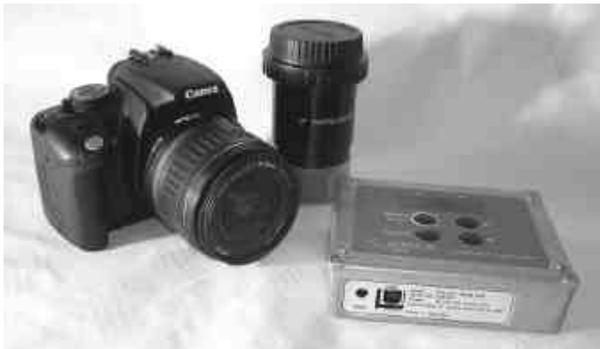
APN avec son objectif, son boîtier de contrôle Cercis et son adaptateur au coulant 2"
