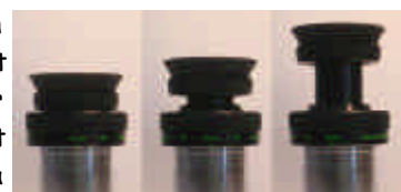
La rotation de la bague permet de passer de 4mm à 2mm par demi-pas
