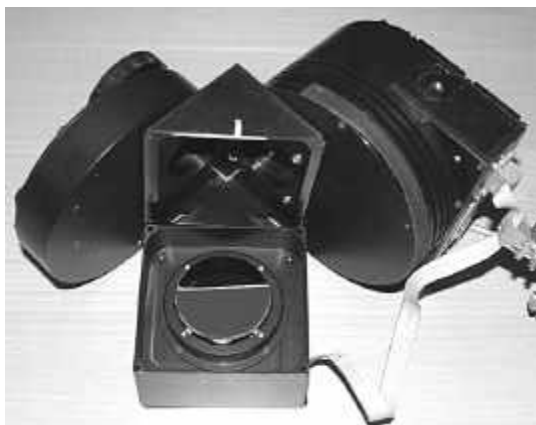
L'AO-7 a été démonté permettant de voir le petit miroir circulaire mobile. Le système est installé entre une roue à filtres (à gauche) et une caméra CCD (à droite). Observez l'entrée optique perpendiculaire à la sortie
