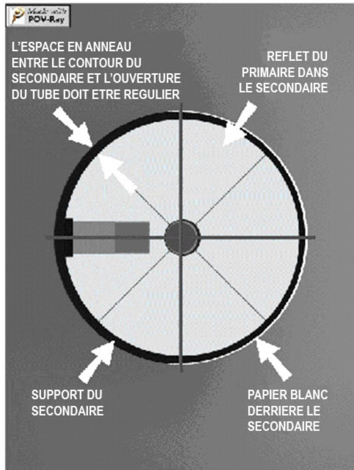
régle de celui-ci ou insérant des rondelles ou des cales sous les vis de fixation. L'illustration de droite montre ce que l'on voit dans l'ocillon du tube de visée quand le secondaire est correctement centré.
