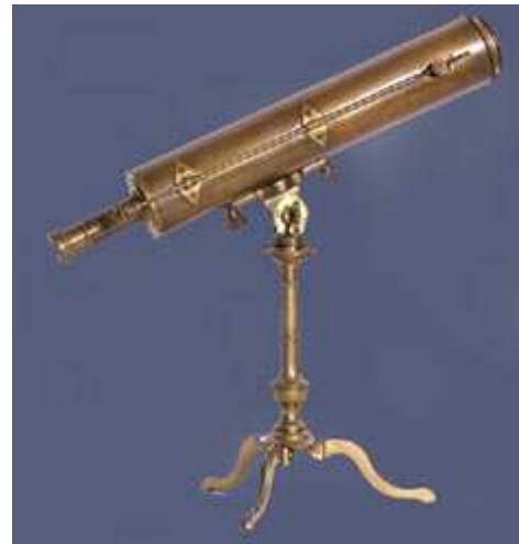
Fig.2 Télescope Grégorien, XVIIIe siècle. La mise au point s'opère en bougeant le miroir secondaire.
