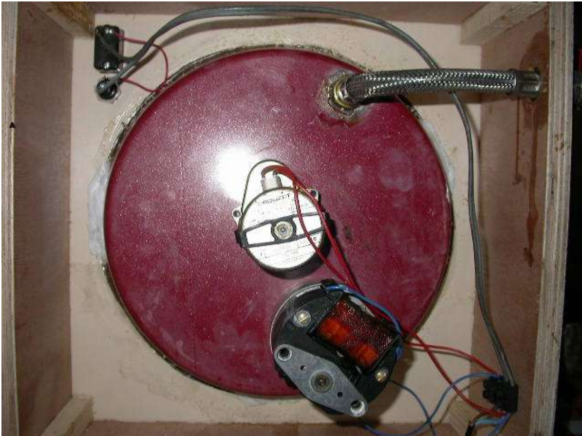
Fig.2 Vue sur l'intérieur de la machine. Les deux moteurs sont fixés sur le plat rouge. En haut à gauche, l'interupteur et le fusible en haut plus à droite, le tuyau de vidange soudé sur le plat.
