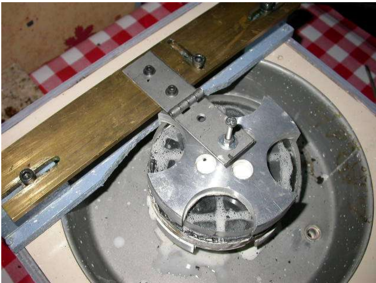
Fig.4 Usinage miroir dessus et vue sur les rainures de guidages.
