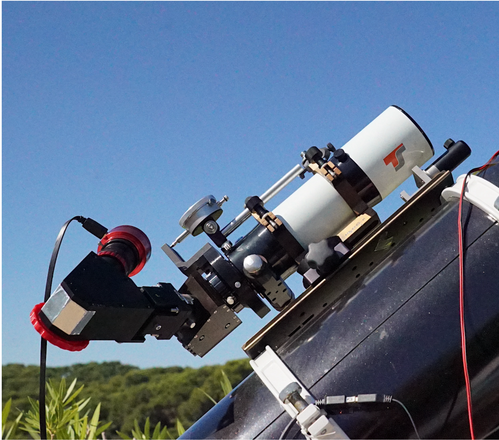
Utilisation d'une hélioscope d'Herschel pour atténuer le flux
