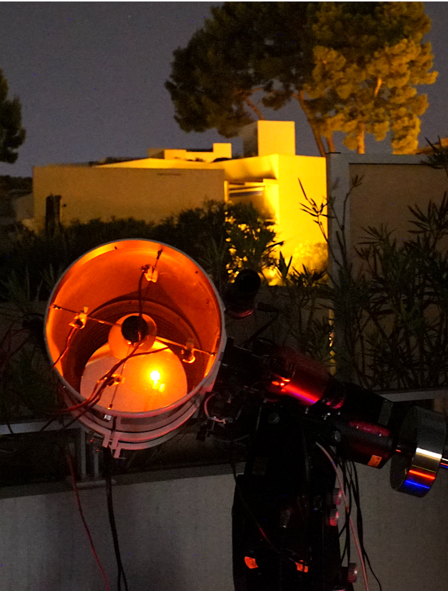
Lampes néon placées dans la pupille d'entrée du télescope
