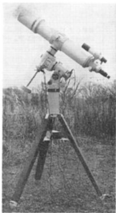
●FC-125N鏡筒とEM-200赤道儀をセットにしたFC-125SE。鏡筒の素材を軽量化したが、レンズの重量はそのままなので、バランスを合わせると鏡筒の下部が長くなって、やや不格好となってしまふ。クランプ類にも手とどきにくい。標準装備の延長筒は、背丈が高くなり、のぞきやすくなる。
