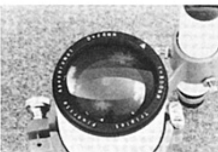
▲フローライトの両凸を中央に配した三枚玉対物レンズ。焦点距離は主焦点時320mmなのに表示はなぜか300mmとなっている。
