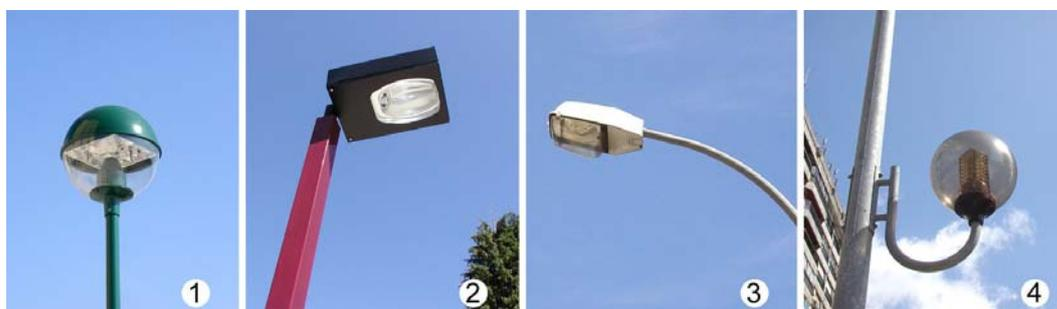
**Fig. 2.** Diferentes sistemas de iluminação. O candeeiro 1 impede a projecção de luz para cima e tem pouca emissão para os lados. O modelo 2 é ainda melhor; o candeeiro 3 é bastante mau com emissão considerável para os lados e acima da horizontal; o modelo 4 é um exemplo gritante de ineficácia e prejuízo: ilumina para cima e para os lados mas *não* para baixo. E incomoda. Apesar disso, não é difícil encontrá-lo nas nossas ruas. Guilherme de Almeida (2007).
