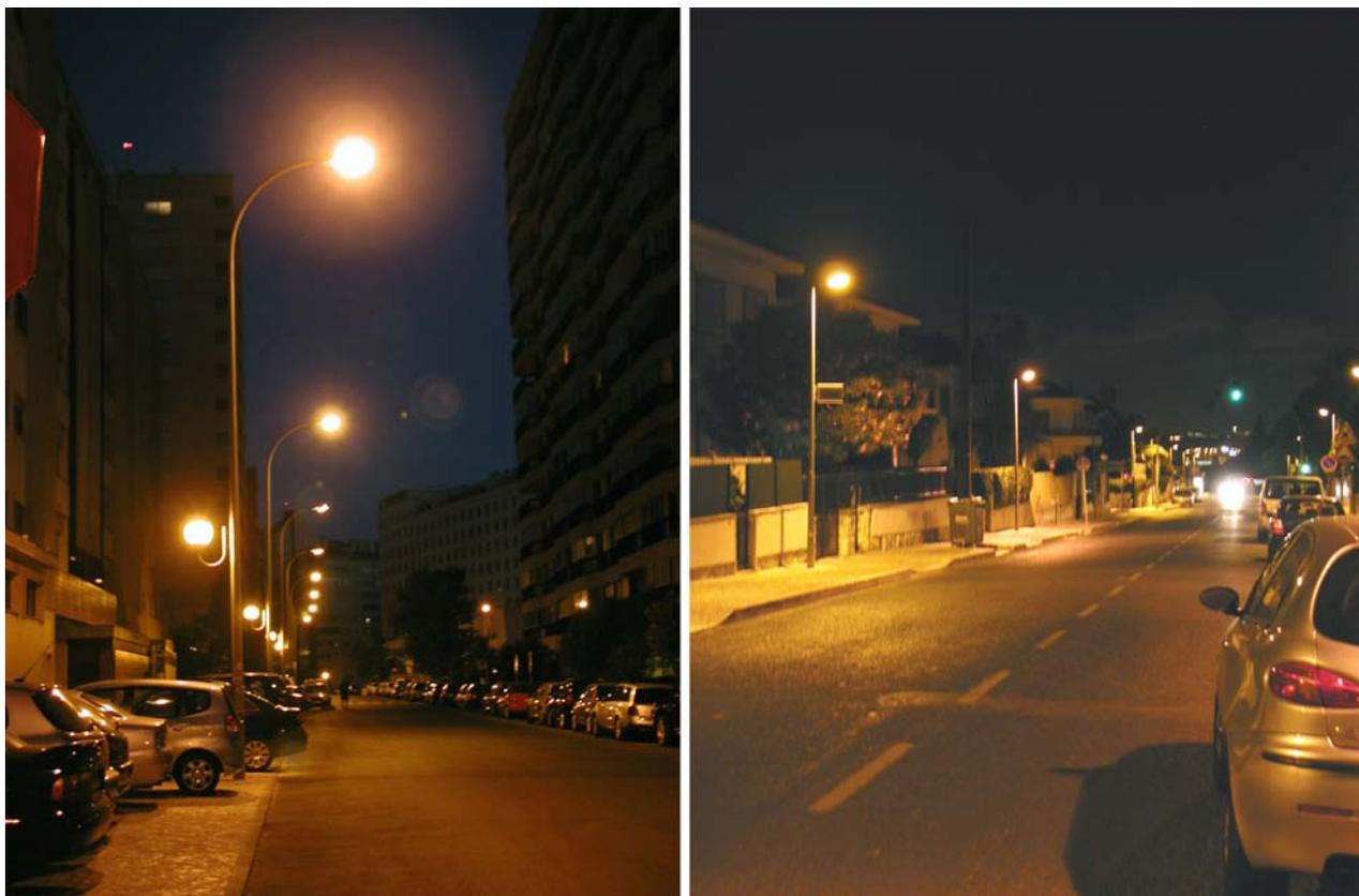
**Fig. 3.** Duas ruas iluminadas. Na fotografia da esquerda, os candeeiros (dos tipos 3 e 4 da figura anterior) emitem bastante luz para os lados e para cima. Na fotografia da direita, os candeeiros (do tipo 2 da foto anterior), são mais direccionados para baixo. O solo desta rua tem muito melhor iluminação. Guilherme de Almeida (2007).
