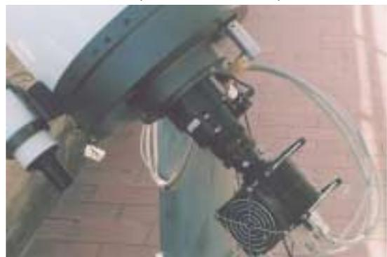
**Figura 3.** La telecamera Hi-SIS 22 al fuoco diretto del MEADE SSC 10" dell'autore. Sono visibili il foccheggiatore NGF-S ed il riduttore di focale Celestron nella posizione b. descritta nell'articolo.
