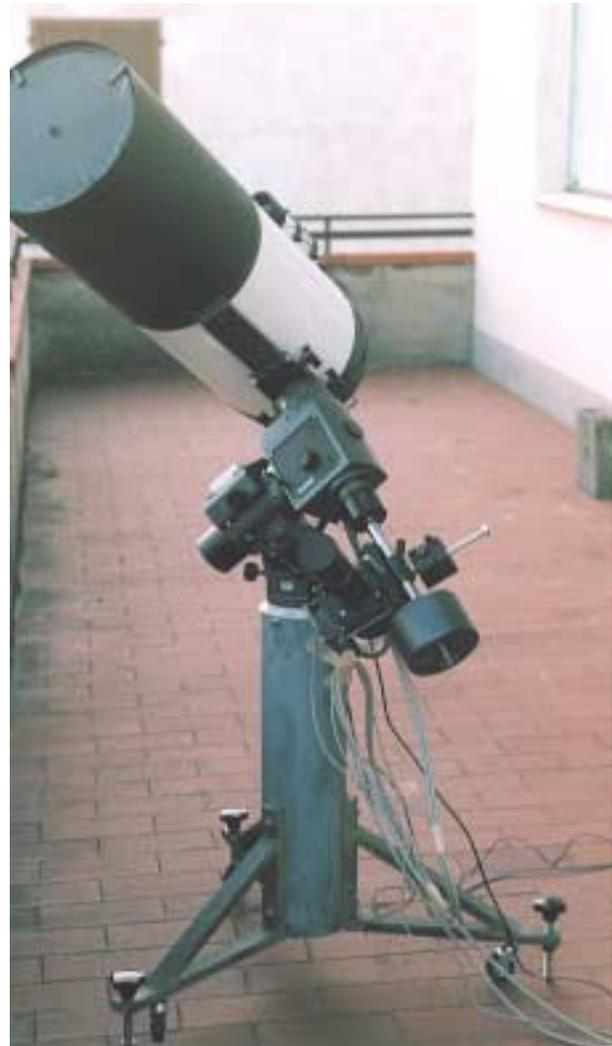
**Figura 5.** Il telescopio messo in postazione. Si può notare la telecamera Hi-SIS 22, posta in questa occasione "in parallelo" con un teleobiettivo da 135mm, mediante un supporto autocostruito, sull'asse di declinazione, in posizione di contrappeso allo strumento principale. Sono pure ben visibili i vari cavi di alimentazione e di collegamento
