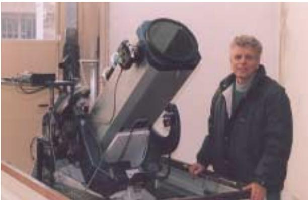
Figura 2. Piero Lavoratti con il suo strumento, uno Schmidt-Newton 250 mm f/5 con montatura a culla.
