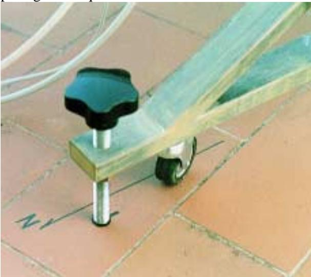
**Figura 4.** Particolare del pavimento e di un piede della colonna. La vite è già adagiata in uno dei fori di riferimento per la postazione. Una volta messo "in bolla" il telescopio risulta perfettamente in postazione.
