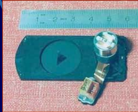
Otturatore elettromeccanico di recupero da telecamera professionale
