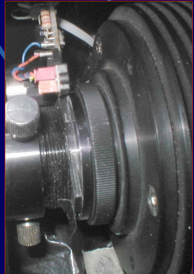
Inserimento nel "naso" da 31,8mm della camera CCD
