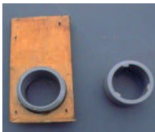
Bague extérieure finie et pièce brute munie des 3 taquets d'arrêt
