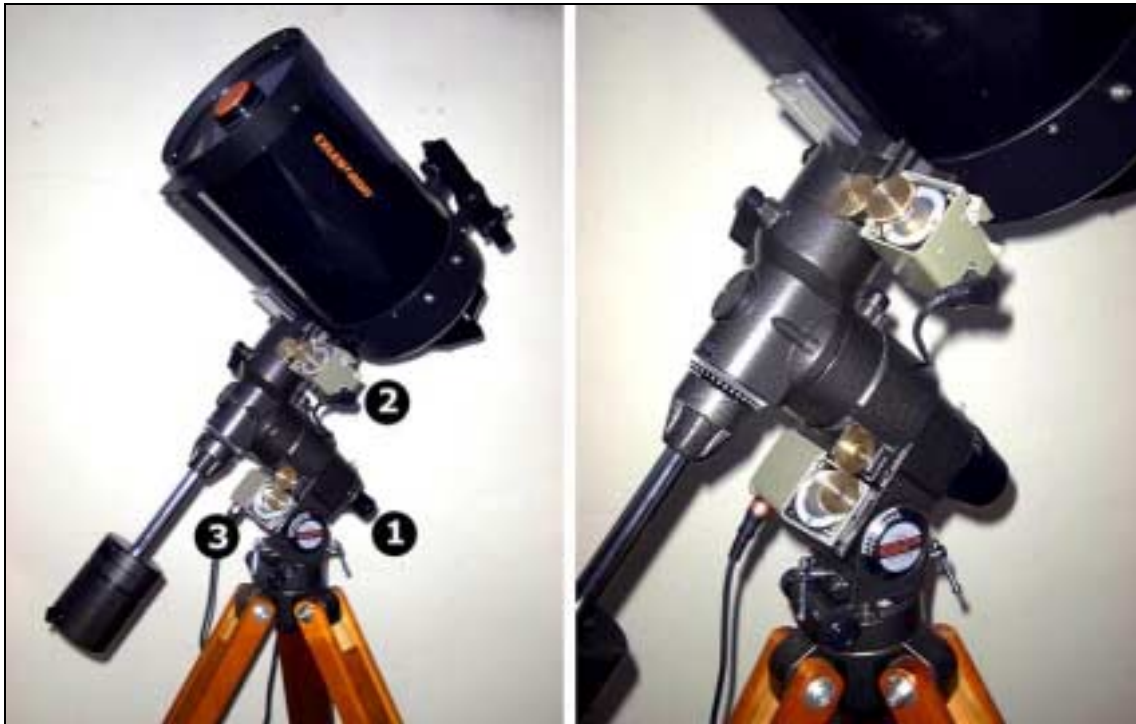
Figura 5.4- Montagem alemã Vixen GP , telescópio Schmidt-Cassegrain C8: 1- buscador polar; 2- motor de passos, eixo de declinação; 3- motor de passos, eixo de ascensão recta.
