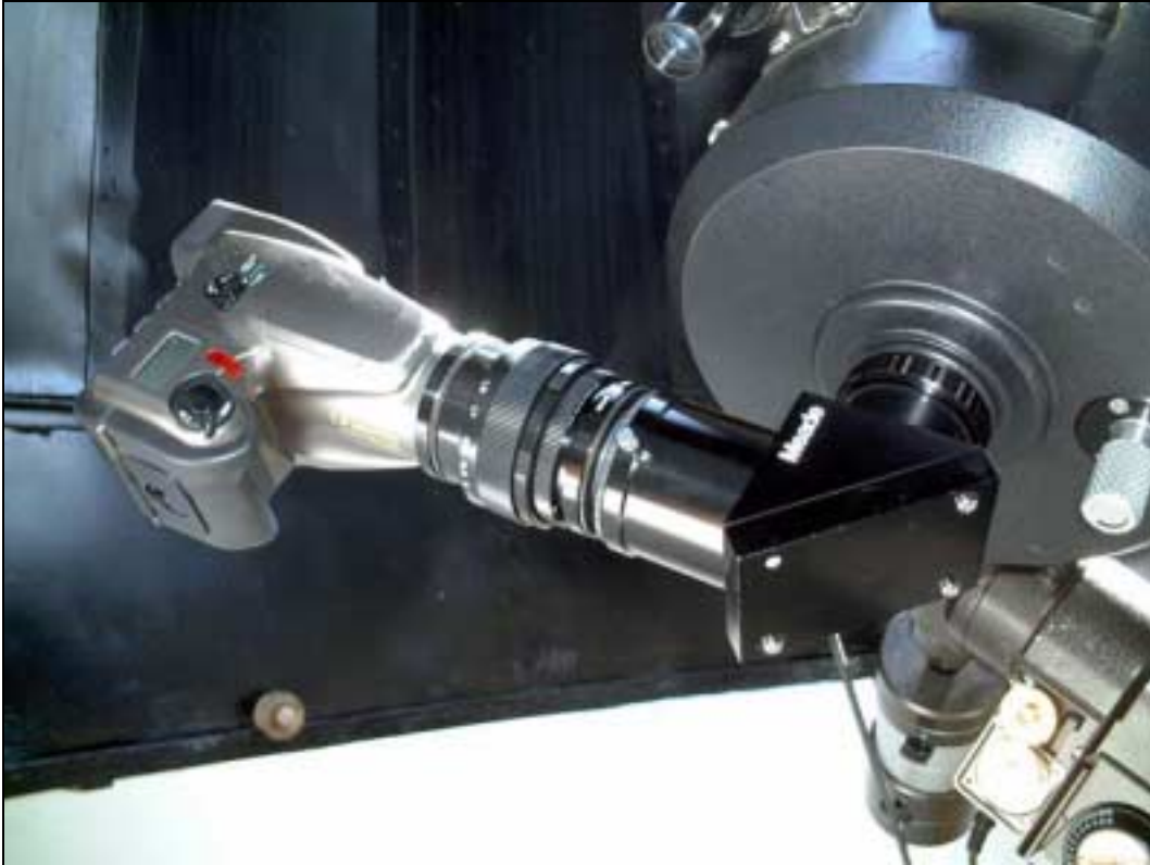
Figura 5.16- Sistema de projecção afocal. Telescópio Schmidt-Cassegrain 200 mm f/10 , objectiva 80 mm 1:2.8 e Olympus Camedia C-1400L .
