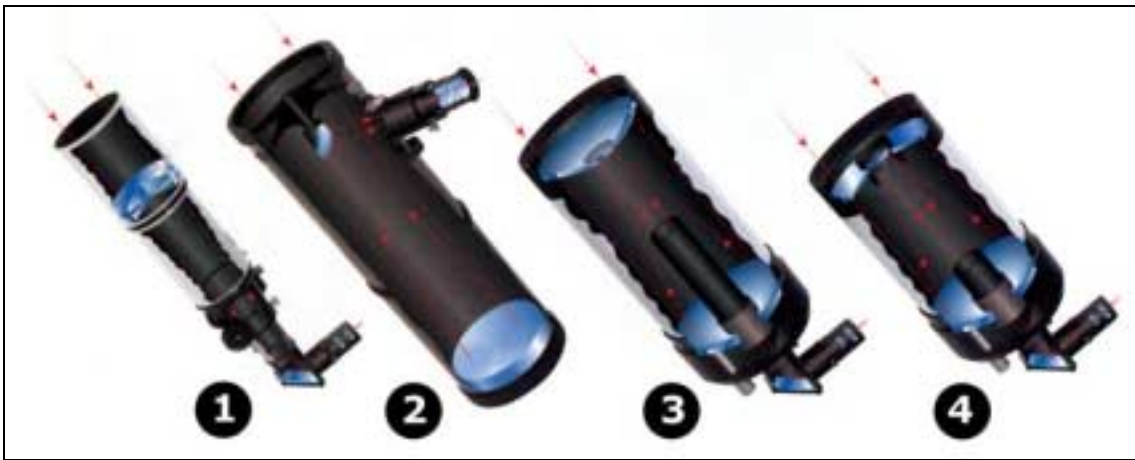
Figura 5.1- Principais tipos de telescópios: 1- Telescópio refractor; 2- telescópio reflector; 3- telescópio catadióptrico (Maksutov-Cassegrain); 4- Telescópio catadióptrico (Schmidt-Cassegrain).
