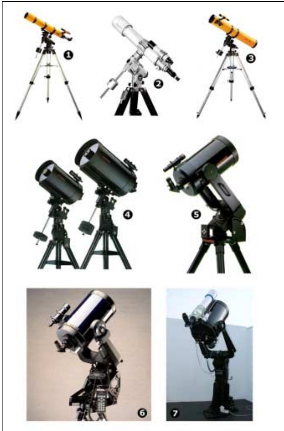
Figura 5.3- Exemplos de algumas montagens equatoriais fotográficas: 1- Montagem alemã, refractor acromático Konus 100 f/10 ; 2- Montagem alemã EM10, refractor apocromático Takahashi FS102; 3- Montagem alemã, reflector Konus 114 mm f/8 ; 4- Montagens alemãs CM1400 e CM1100, telescópios Schmidt-Cassegrain C11 e C14; 5- Montagem de garfo, telescópio Schmidt-Cassegrain C8; 6- Montagem de garfo, Meade LX200 10"; 6- Montagem de garfo, C14 e refractor apocromático Takahashi FS102.
