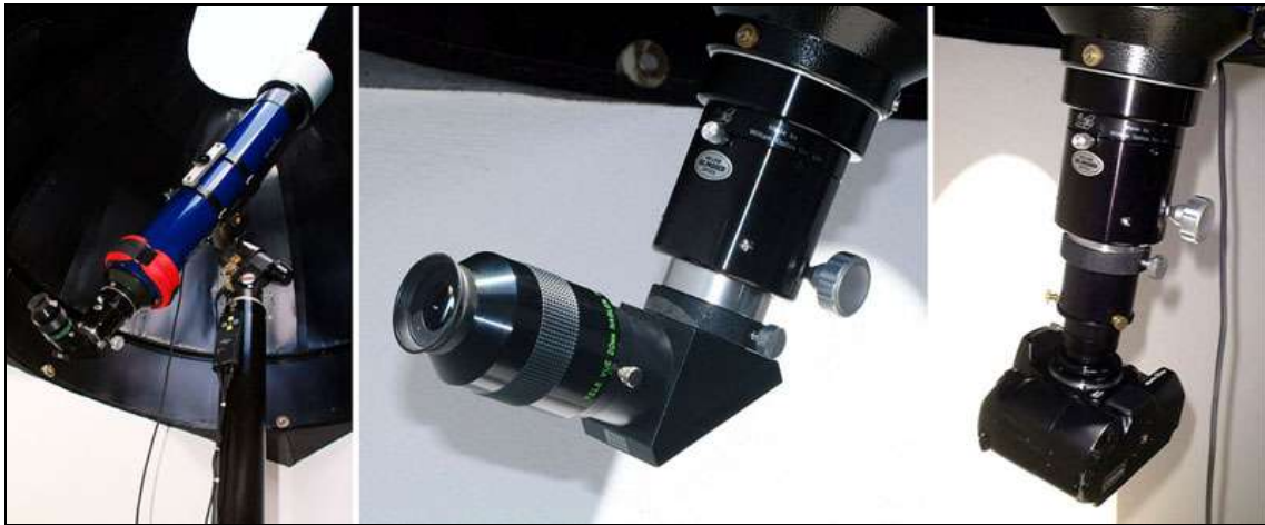
Figura 8- Refractor Synta (Sky-Watcher) 150 mm f/8 + porta-oculares Crayford + Chromacor (esquerda). Porta-oculares Crayford e ocular TV Nagler 20 mm (centro). Porta-oculares Crayford e câmara digital reflex FujiFilm S1 Pro . Pedro Ré (2002).
