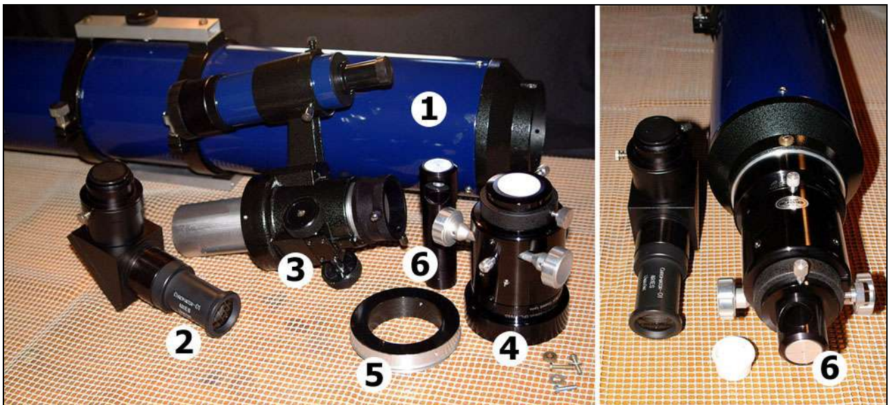
Figura 6- Montagem de um novo porta-oculares num refractor Synta ( Sky-Watcher ) 150 mm f/8 : 1- Refractor; 2- Chromacor ; 3- Porta-oculares de cremalheira (original); 4- Porta-oculares Crayford (novo); 5- Adaptador; 6- Ocular Cheshire . Pedro Ré (2002).
