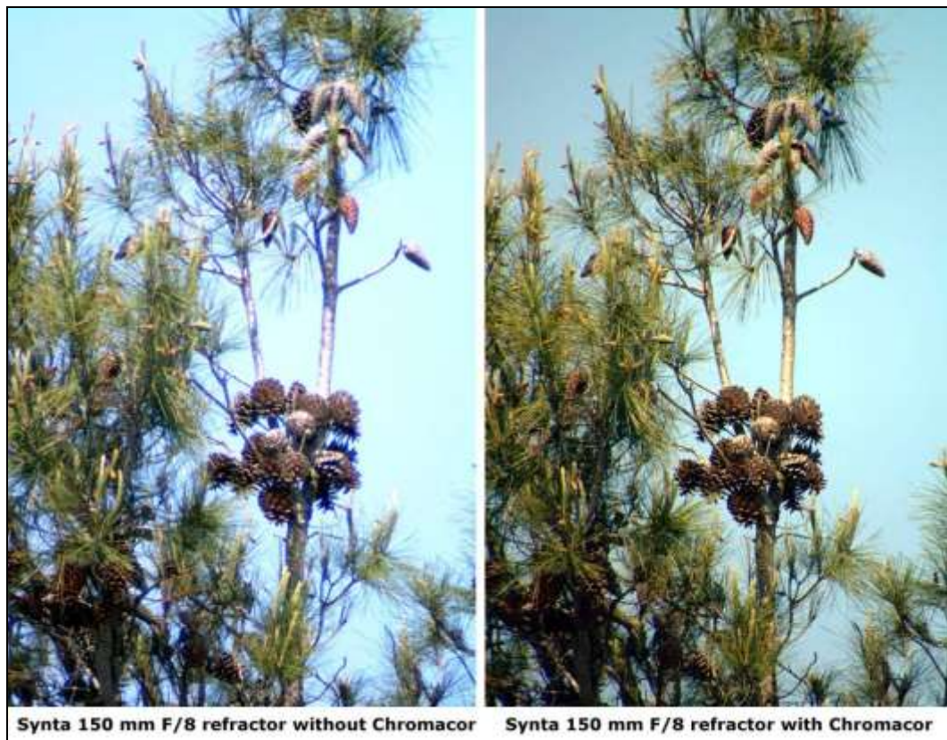
Figura 3- Imagens de comparação de um pinheiro sem (esquerda) e com (direita) Chromacor . Refractor Synta (Sky-Watcher) 150 mm f/8 , câmara digital reflex FujiFilm S1 Pro . Pedro Ré (2002). Imagem colorida em http://www.astrosurf.com/re/chromacor.html
