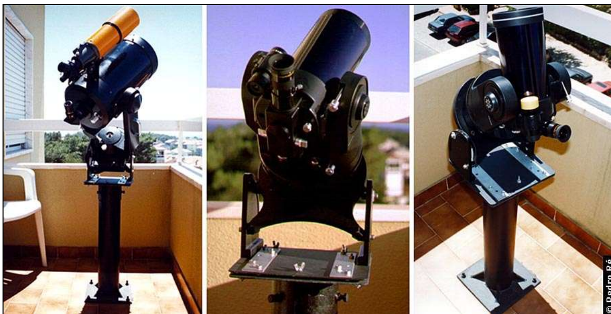
Figura 2- Pilar que permite a montagem de diversos instrumentos.
