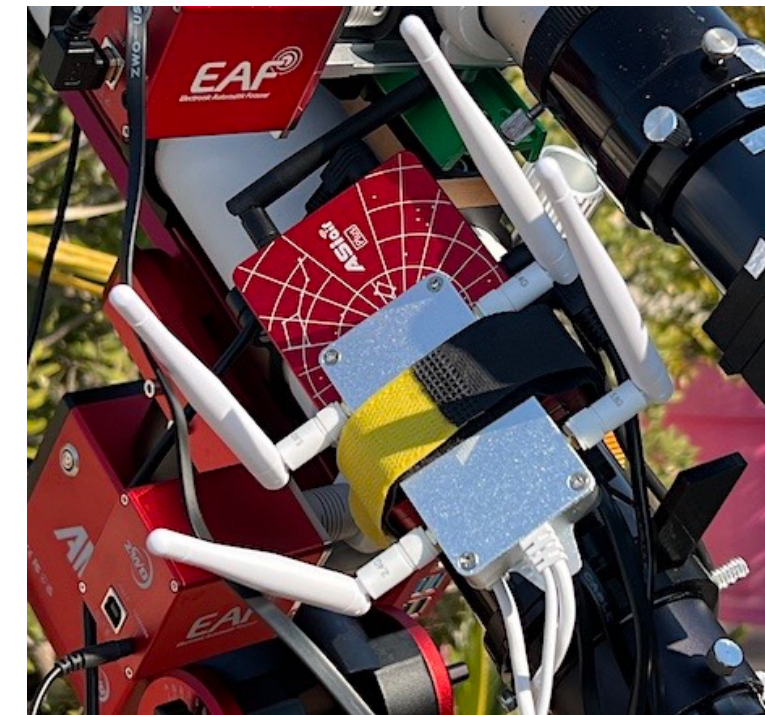
L'acquisition d'un spectre, en plus des fonctions de centrage et de guidage, avec un seul système ASIAir est possible, mais ce révèle acrobatique (en raison du nombre limité de caméras pouvant fonctionner indépendamment dans le système). Il faut alors assumer l'usage de deux ASIAir de concert).
