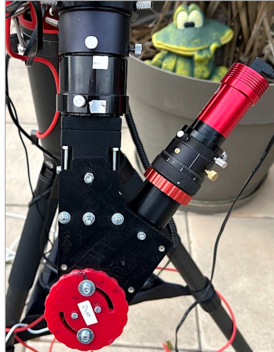
Un pur Sol'Ex transformé instantanément en un Star Explorer (Star'Ex HR) grâce au principe de la spectrographie sans fente. Poids = 565 grammes
