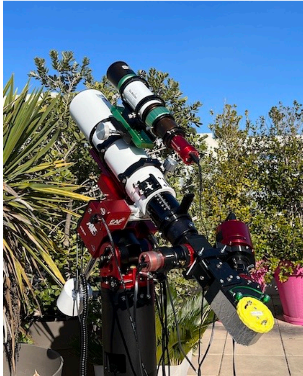
Lunette compacte (TS80/480 mm) Monture GoTo (ZWO AM5) Observation en ville (Antibes)
