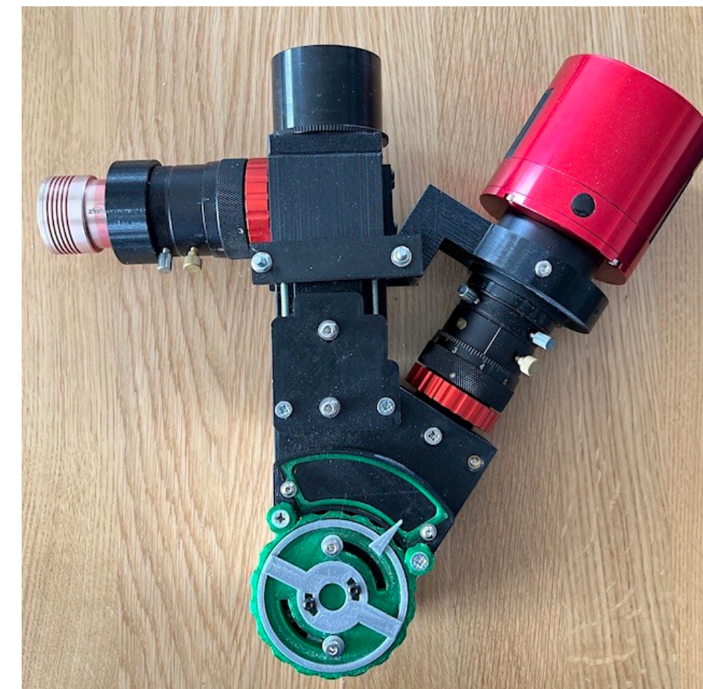
Star'Ex avec système de guidage sur fente.
