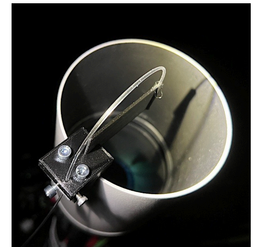
La sortie de la fibre éclaire l'objectif en permanence (pièces impression 3D)
