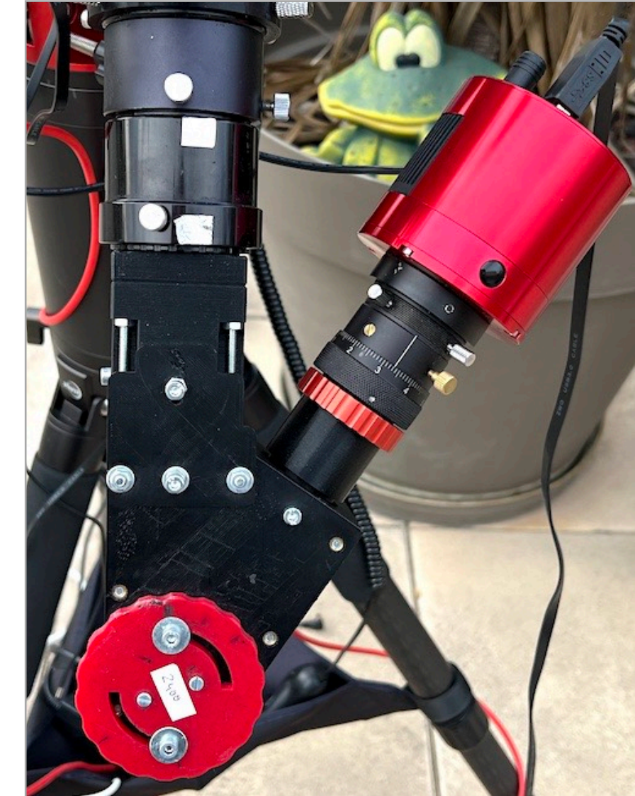
Spectrographie sans fente « haute résolution » avec un Sol'Ex équipée d'une caméra refroidie pour les cibles de faible éclat (ASI183MM pro, ASI533MM pro, ...). Poids = 970 grammes
