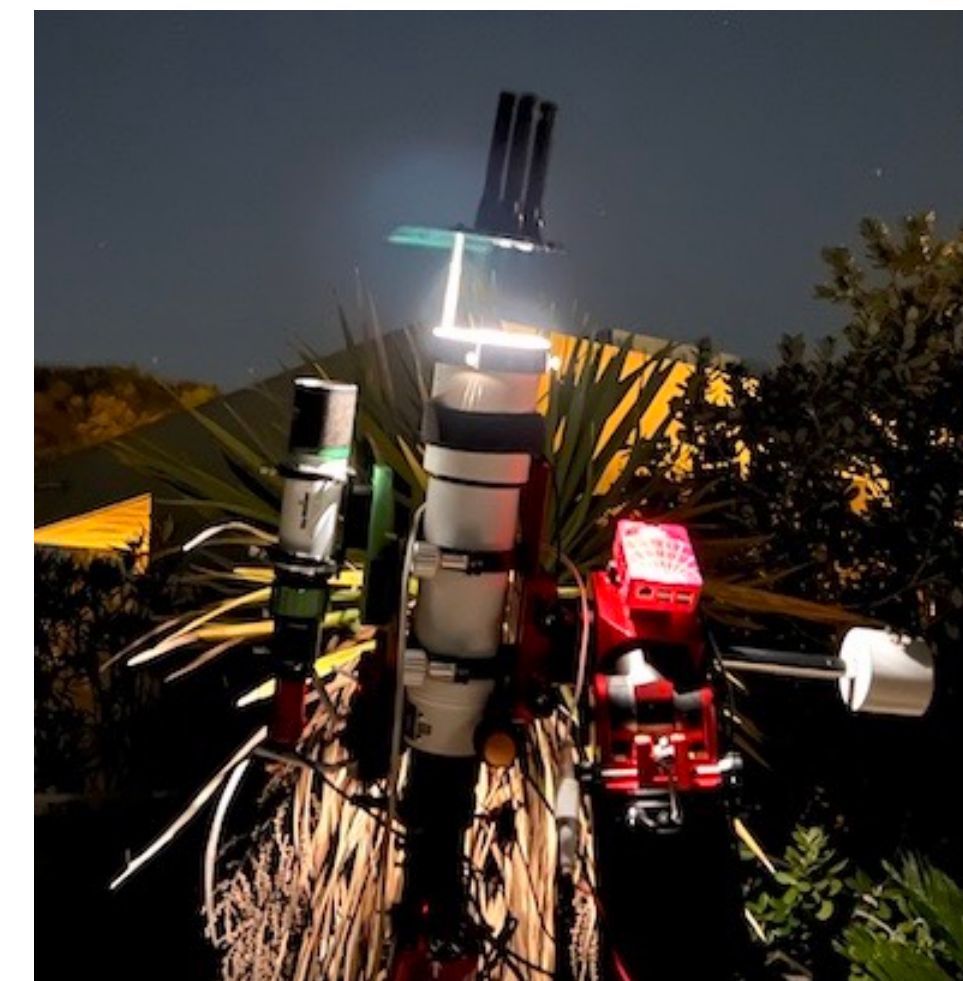
Etalonnage « low cost » (lampes torches sur pile)
