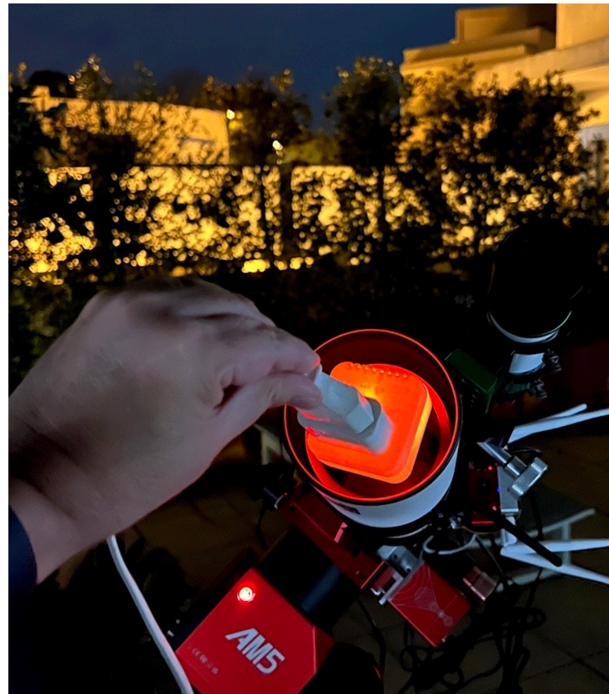
L'étalonnage en longueur d'onde (on ajoute d'une règle dans l'image de spectres) : une veilleuse néon tenue à la main.
