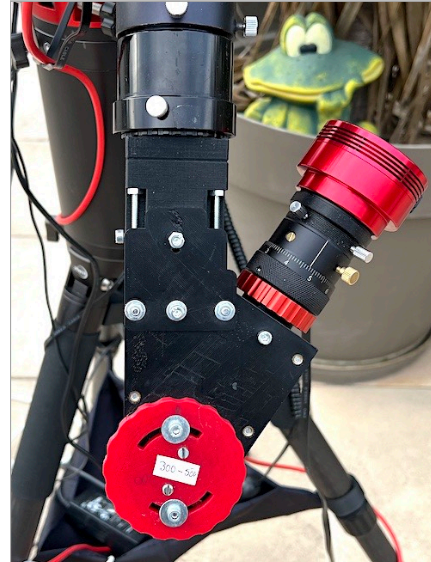
Configuration « basse résolution » (Star'Ex LR) avec réseau 300 t/mm. La caméra peut être non refroidie pour les cibles brillantes, couleur ou noir et blanc. Capacité de pratiquer le Live Stack en spectro.
