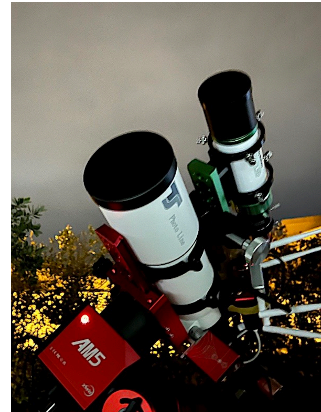
L'étalonnage en bias et dark (signal thermique) : un simple bouchon devant l'ouverture.
