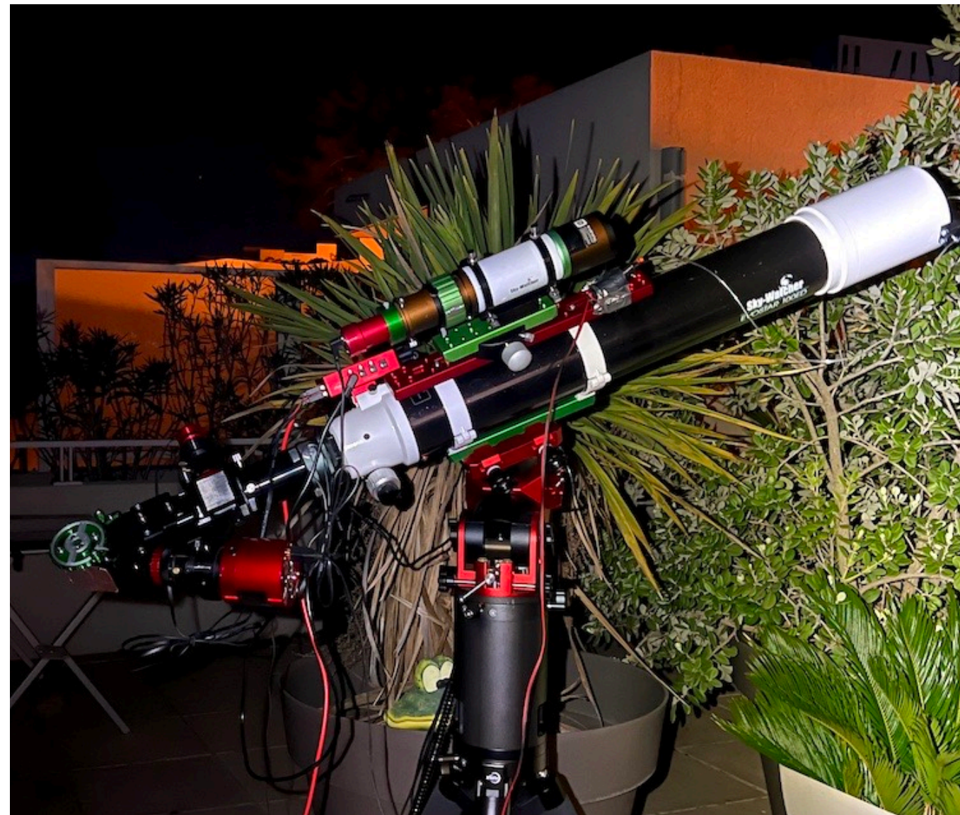
Lunette de 100 mm relativement économique (SW 100ED) équipée d'un spectrographe Star'Ex HR
