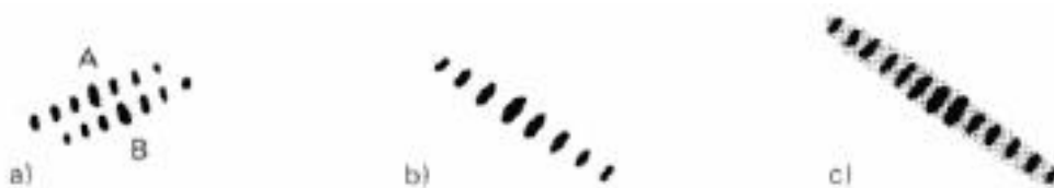
Figure XII.21 - Observation des étoiles doubles par interférométrie. a : système de franges obtenu en observant un couple A-B ; b : juxtaposition des franges de A et de B : netteté maximale des franges ; c : alternance de franges de A et de B : bande continue.
