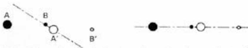
Figure XII.18 - Mesure de \theta en double image. A gauche, alignement non réalisé ; à droite, alignement réalisé. Plus B et A' sont proches, plus cette technique est sensible.
